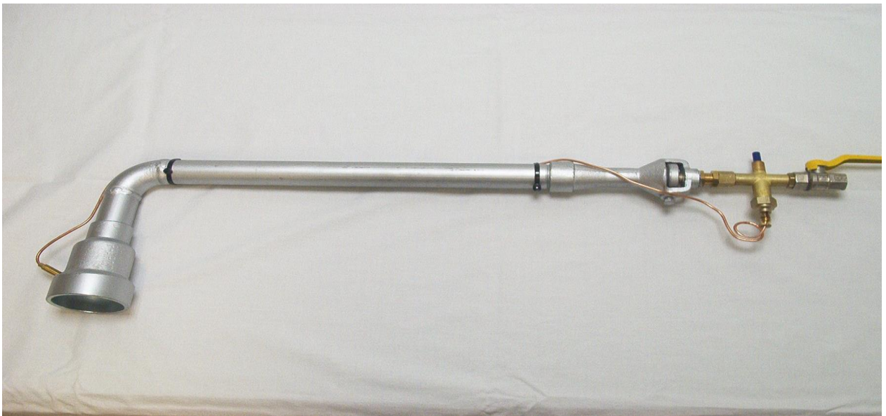
Anwärmbrenner mit Injektor und thermoelektrischer Flammenüberwachung
